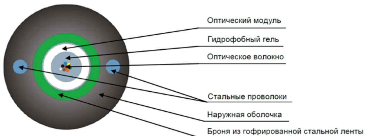
Кабель содержит оптический модуль со свободно уложенными волокнами. Свободное пространство в оптическом модуле заполнено гидрофобным гелем. Поверх модуля накладывается броня из гофрированной стальной ленты и оболочка из полиэтилена средней плотности, стойкая к УФ-излучению. Свободное пространство под гофрированной лентой заполнено гидрофобным гелем. В оболочке кабеля диаметрально противоположно расположены две стальные проволоки, которые выполняют функции силовых элементов.
